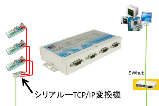
図 5：シリアル TCP/IP 変換機を使ったネットワーク
